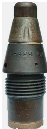
18. ábra. V-429 gyújtószerkezet „57” kódszámmal (a szerzők felvétele)
