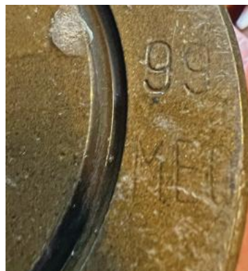
19. ábra. A 99 gyár jelölése egy 57 mm-es légvédelmi géppágyűhüvelyen (a szerzők felvétele)
