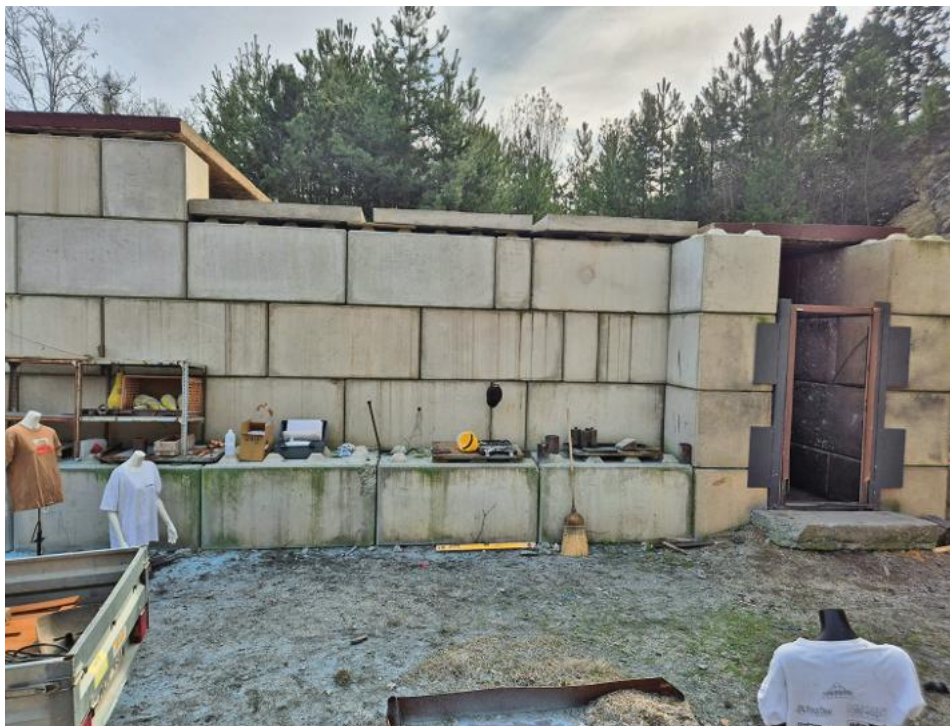
6. ábra. A CerTrust Vizsgáló és Tanúsító Kft. balatonfűzfői robbantó kamrája befogadó ajtókerettel (Szalkai L. és Daruka N. felvétele)
