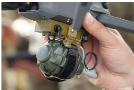
1. ábra. 3D-nyomtatással készített kioldószerkezet egy quadrokopteren (АрміяInform) [5]
