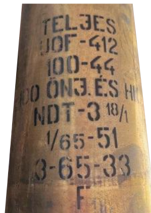
10. ábra. 3-65-33 sorozatszám egy 100 mm-es harcokcsígyú hüvelyen (a szerzők felvétele)
