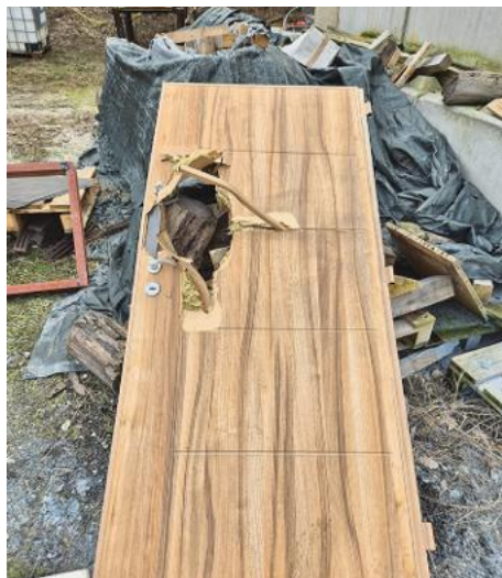
7–8. ábra. Összpontosított töltetházelhelyezés (Szalkai L. és Daruka N. felvétele)
