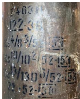
17. ábra. különböző „53”-as gyárból származó lőporsorozatszámok egy 122 mm-es Z-463M hüvelytöltényen (a szerzők felvétele)
