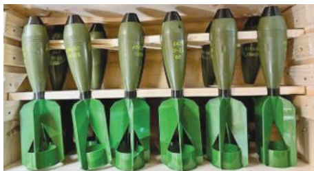
3. ábra. 60 mm-es aknavető gránát FPV-löszerré alakítva (Ukrainian Armor) [8]
