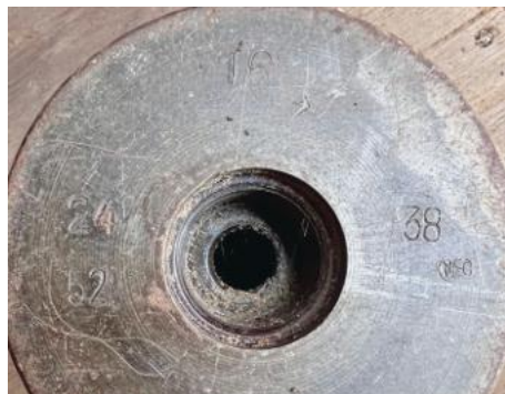
15. ábra. 38-24-52 sorozatszám egy 76 mm-es tűzérségi hüvelyen (a szerzők felvétele)
