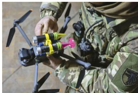
2. ábra. 3D-nyomtatott kioldószerkezet (IEEE Spectrum) [6]
