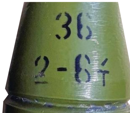
13. ábra. 36-2-64 sorozatszám egy 57 mm BR-281 pct. gránáton (a szerzők felvétele)
