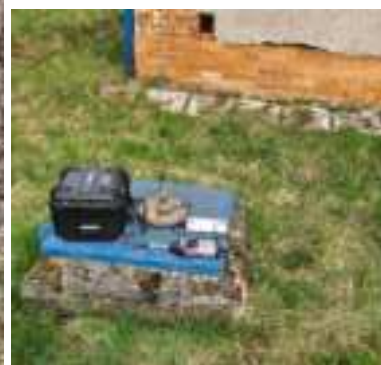
Obr. 5 Meracie stanovisko V3a a V3b vodný zdroj Zadná studňa prameň a čerpačka a meracie aparátúry Svantek so snímačmi.
