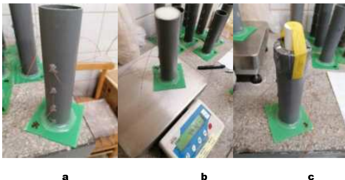
Rys. 7. Kolejne fazy przygotowywania ładunków do pomiaru prędkości detonacji
