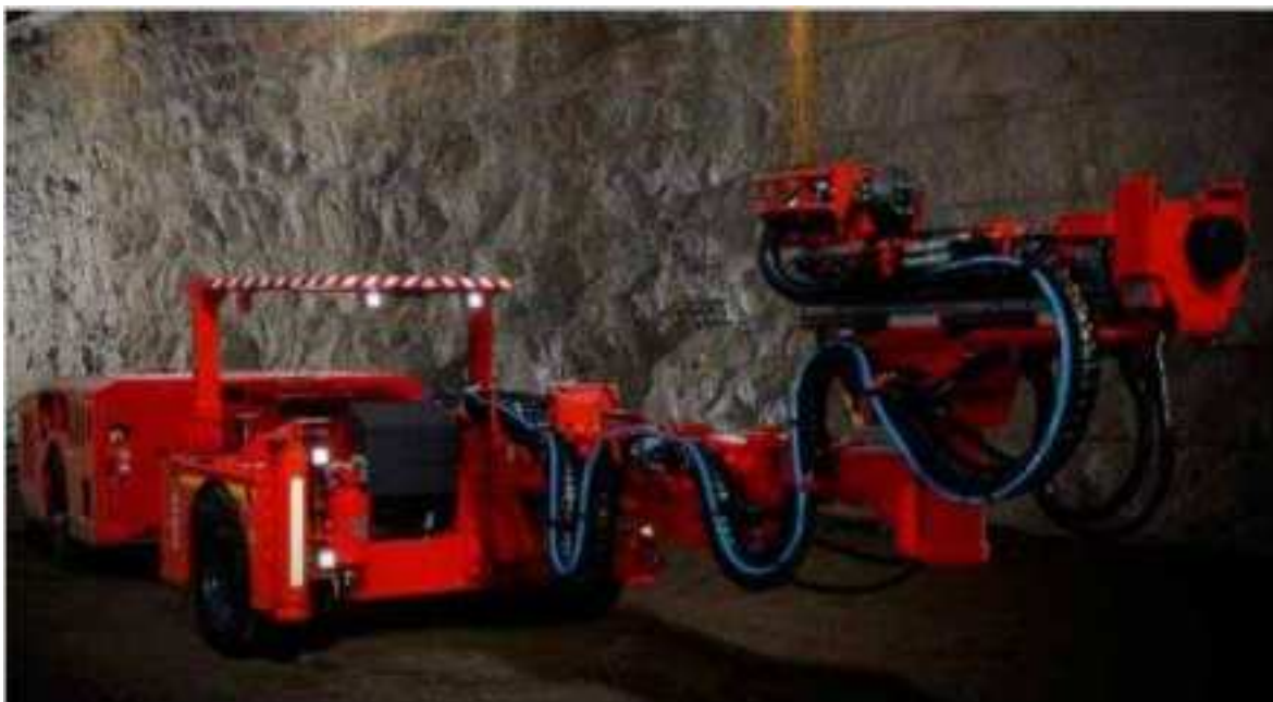
Obr.2 Všestranná nízkoprofilová vŕtacia súprava Sandvik DD211L-V s jedným viacúčelovým výložníkovým ramenom a teleskopickým posunom
