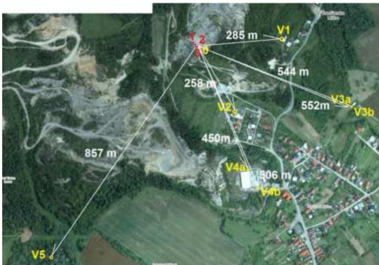
Obr. 3 Pozícia odstrelov 1, 2 a 3 v lome Trenčianske Mitice – Skaličky voči meracím stanoviskám 0 až 7 situovaným v okolí lomu
