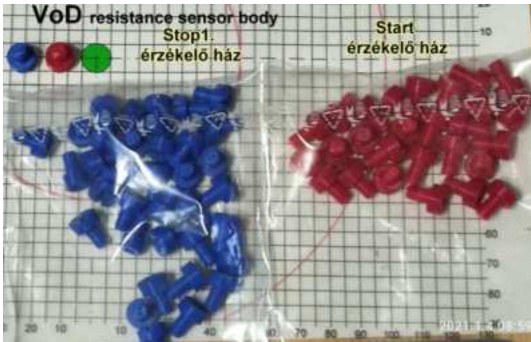
2. kép Érzékelő szonda házak VoD méréshez
