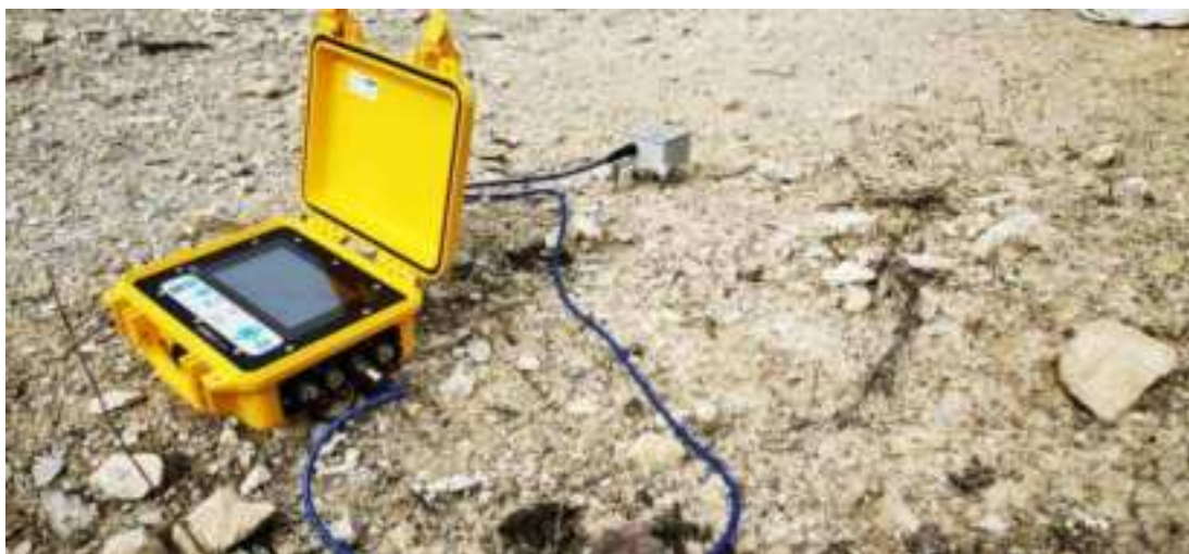
Obr. 4 Meracie stanovisko V0 lom Trenčianske Mitice - Skaličky a meracia aparátúra Vibracord s trojzložkovým snímačom vo vzdialenosti 15 m od iniciačného vrtu odstrelu č. 3, 28 m od iniciačného vrtu odstrelu č. 2 a 45 m od iniciačného vrtu odstrelu č. 1.
