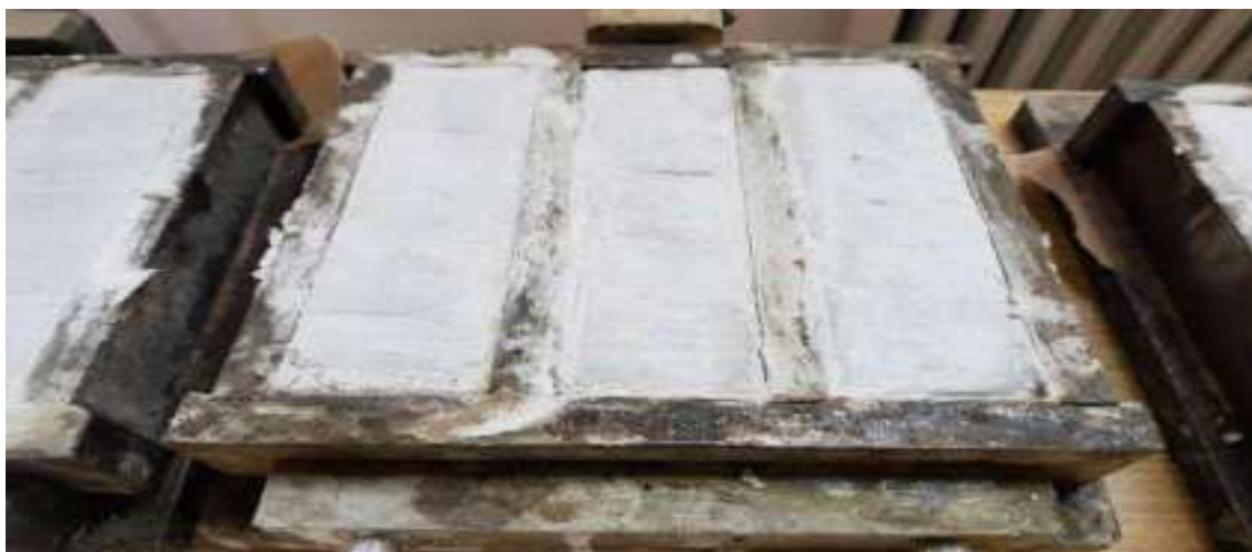
Obr.6 Laboratórne skúšky zmesí - Pripravená vzorka zaliata zmesou a následne zhutnená, zdroj: Autor
