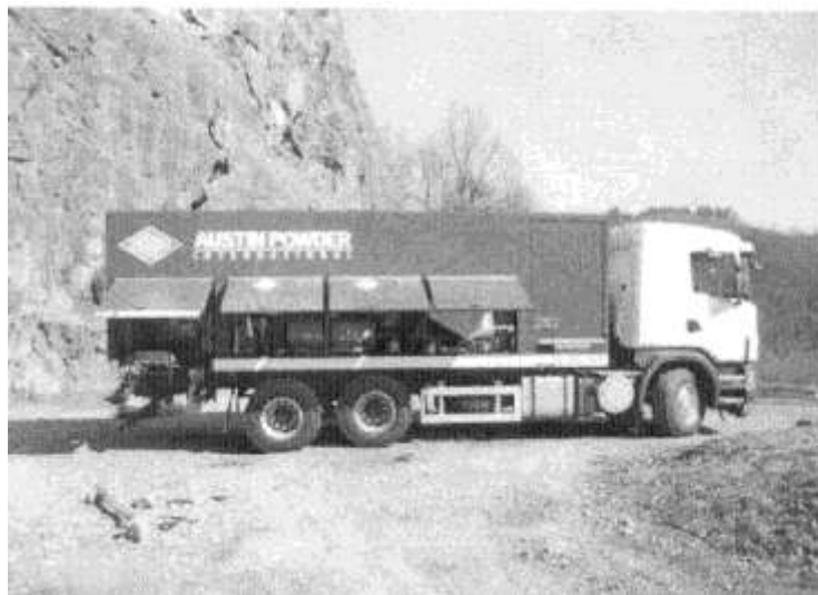
2.7. ábra Haevy ANFO töltésére is alkalmas kocsi fényképe
