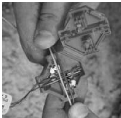
3.6. ábra Az elektronikus gyutacs kötő eleme
