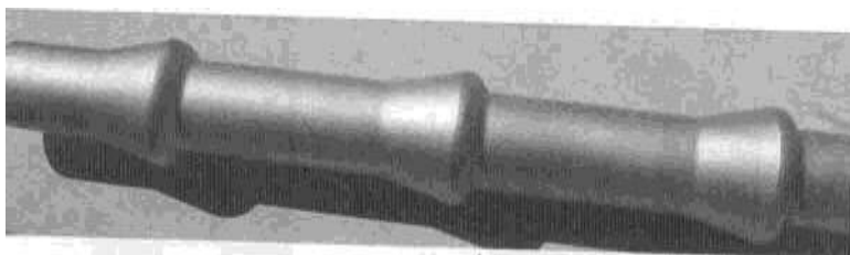
5.21. ábra Robbantással kialakított hőcserélő idom
