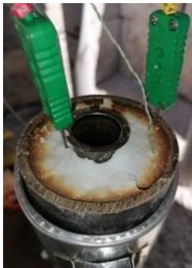
4.kép: 200°C-on a robbanóanyag. Középen a booster helyének a kivehető sablonja.
