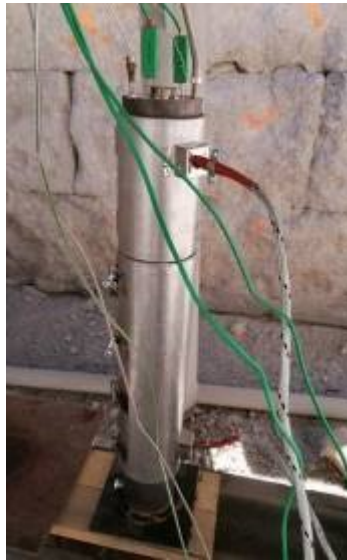
3.kép: A robbanóanyaggal töltött acélcső, fűtőpalásttal, hőmérséklet adatrögzítővel
