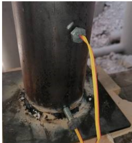
6.kép: A robbantás előtti percekben, a mérőszondák behelyezve.
