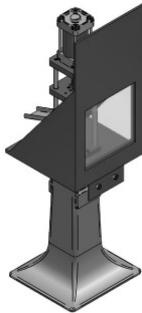
3. ábra: SZB-01 típusú pneumatikus löszerszéthúzó berendezés [10]
