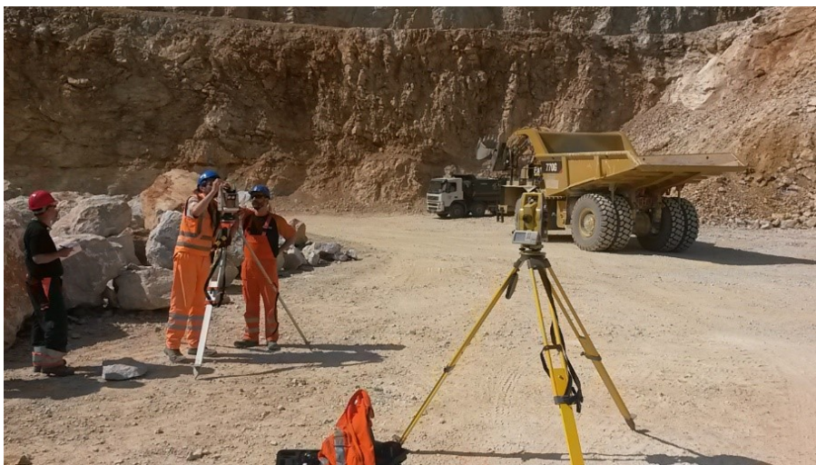
1. ábra Adatgyűjtés a Topcon QS101 teljes állomással és a Pulsar speciális szkennerrel, 2018 Szerbia JelenDo
