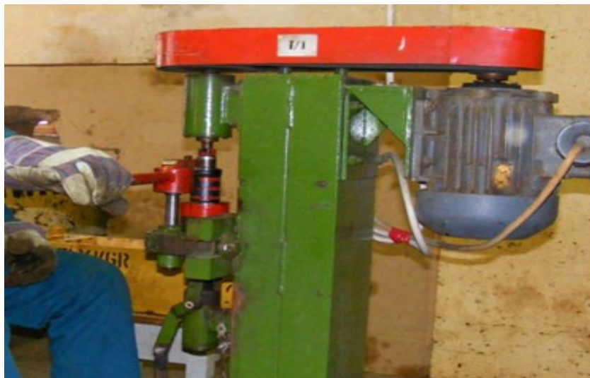
6. ábra: A kézigránát szétvágó gép működés közben 99
