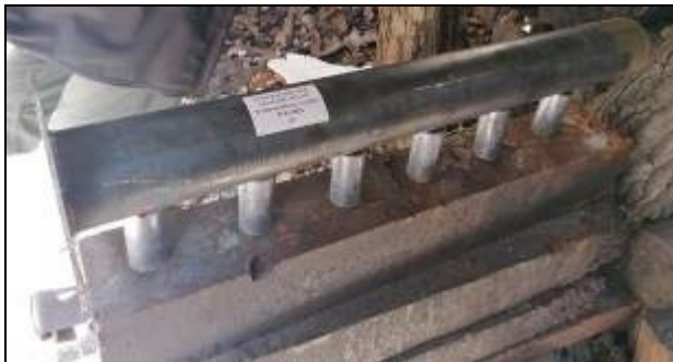
1.kép: AN tartalmú műtrágya robbantásra előkészítve, és az ólomtömbök a robbanás után.
