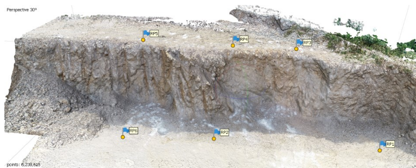
7. ábra – fotogrammetriai mérés kimenete – drónos adatgyűjtés
