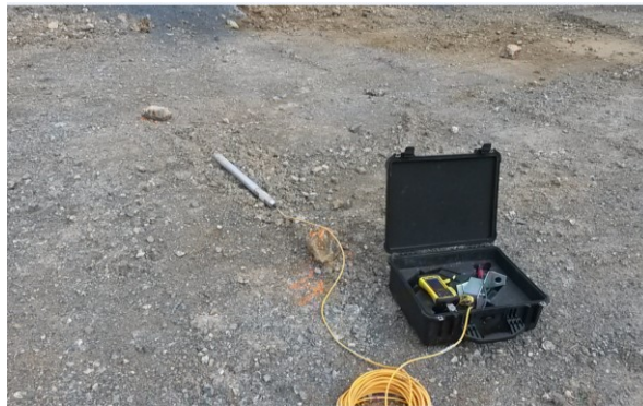
15. ábra Szonda a fúrás előrehaladásának 30 m mélységig történő feltérképezésére
